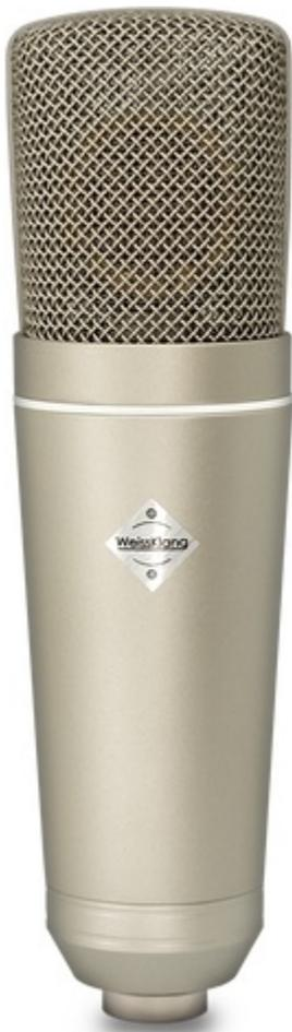
Das Weissklang V17 ist ein Großmembran Kondensator Mikrofon, das laut Hersteller einen natürlichen Klang mit leichter Höhenanhebung bietet. Es verfügt über eine goldbeschichtete und selbst entwickelte sowie gefertigte WMK-17 Kapsel mit Nierencharakteristik. Das Weissklang V17 arbeitet mit einer diskreten Halbleiterschaltung und soll laut Hersteller ein Eigenrauschen von  $< 8$  dBA bieten.
